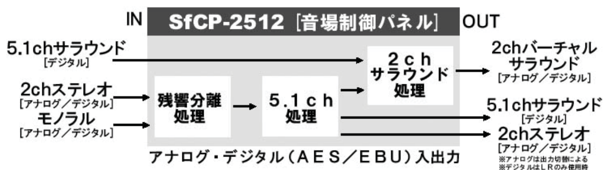
図1 音場制御パネルの入出力
