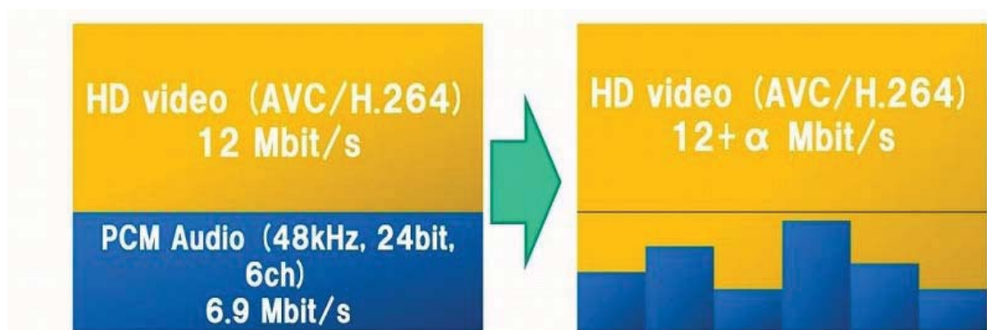
図8 オーディオ信号をロスレス圧縮して得られた余剰帯域を映像に割り当てる例
