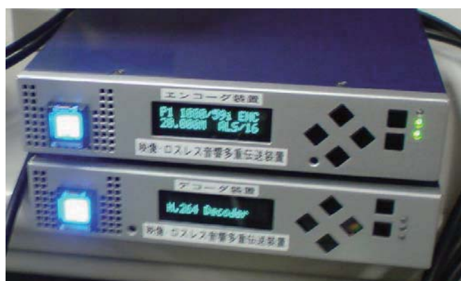
図8 オーディオ信号をロスレス圧縮して得られた余剰帯域を映像に割り当てる例
